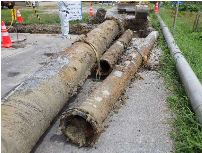
老朽化して撤去した基幹管路（大中地区）
