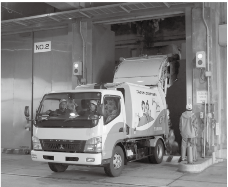
▲収集車からごみ投入（塵芥処理センター）
